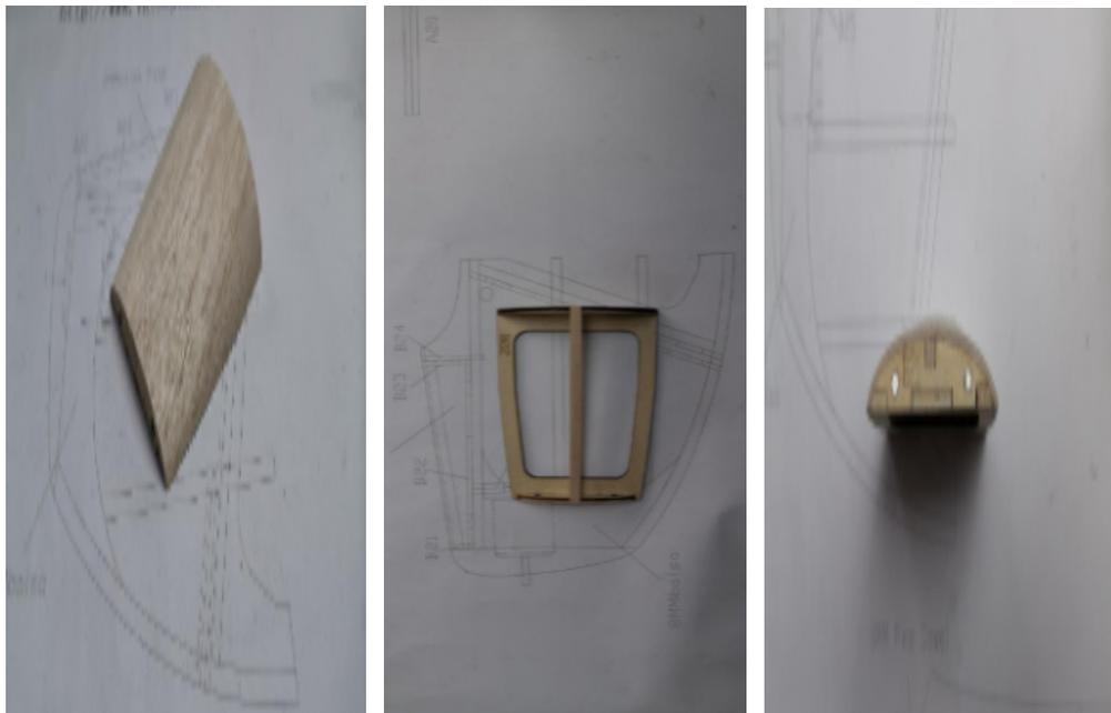
Verbinden Sie die beiden Stücke 8mm Balsa der Nase und kleben Sie sie in den Rumpf.
