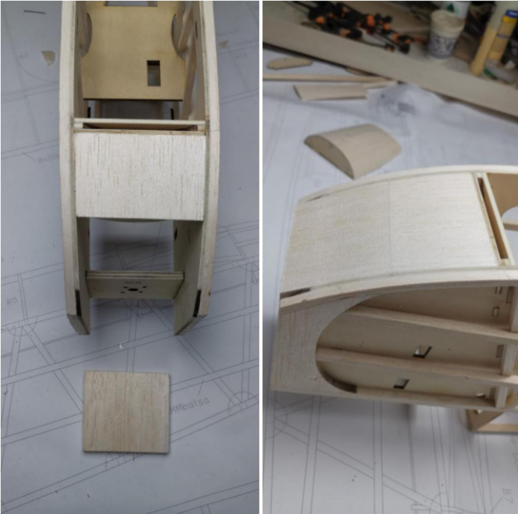
Für den Aufbau der Kabinenabdeckung benutzen Sie Teil B21, B22 & B23. 3x4mm Magneten werden in die entsprechenden Löcher eingelegt. Für die Beplankung wird 2mm verwendet.
