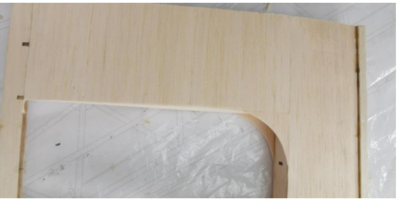
Schleifen Sie die Vorder- und Hinterkante der Tragfläche.
