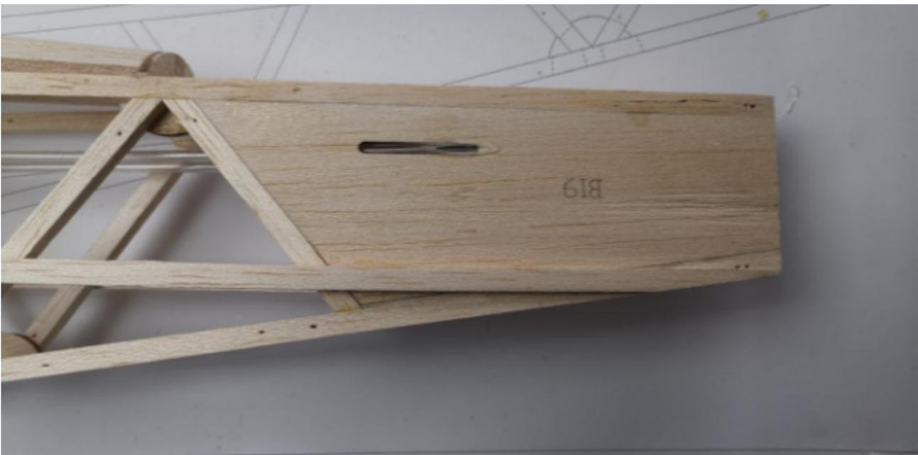
Einbau der Servohalterung.
