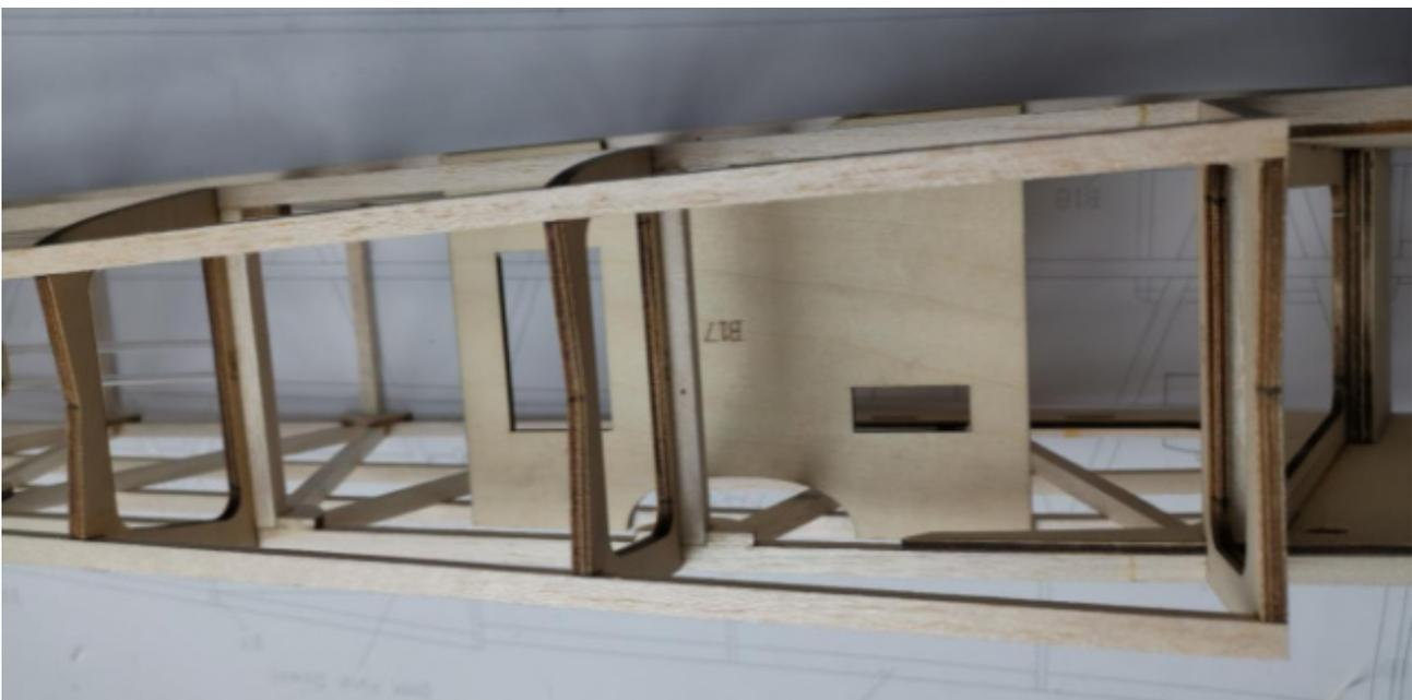
Den unteren Teil des Rahmens mit 8mm Balsastücken verkleiden und glatt schleifen.
