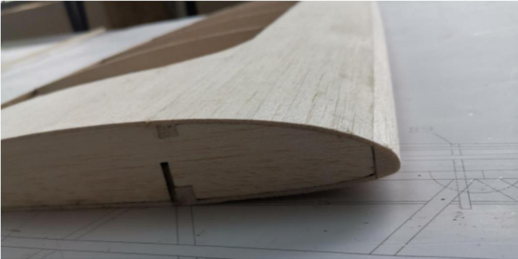
Entfernen Sie die überstehenden Holzteile und setzen Sie den Stab für die Flügelverbindung ein.
